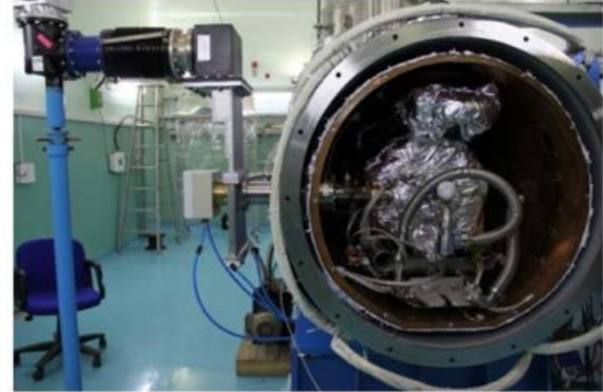
Cavity in HTS cryostat with high power coupler उच्च शक्ति युग्मक के साथ HTS क्रायोस्टेट में कैविटी ।
