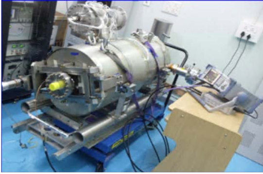
5-cell cavity with tuner and power coupler ट्यूनर व पावर कपलर के साथ 5-सेल गुहा।
