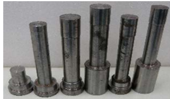
Photograph of 6 variants of fuel punches. ईंधन पंच के 6 प्रकारों की तस्वीर
