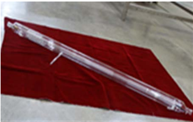
Full length tube developed for CO 2 Laser CO 2 लेसर हेतु विकसित पूर्ण नलिका
