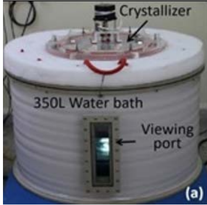
Water bath containing 50 L crystallizer 50 L क्रिस्टलाइज़र युक्त जल कुंड
