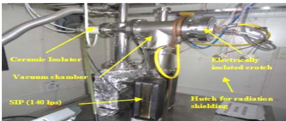
20 keV, 2 kW thermionic DC strip type electron gun. 20 keV, 2 kW थर्मियोनिक डीसी स्ट्रिप इलेक्ट्रॉन गन
