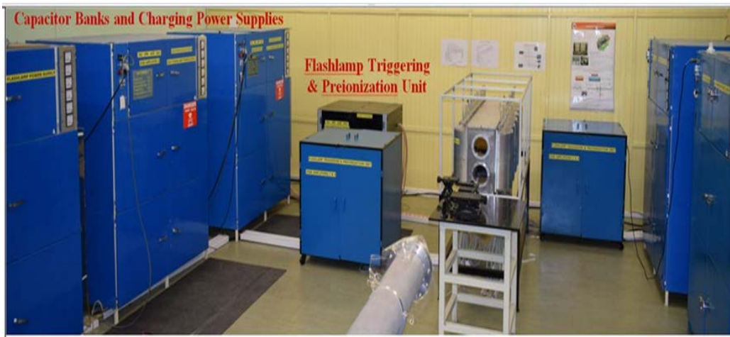
360 kJ Pulsed power supplies for Nd: Glass disc amplifiers. एनडी: ग्लास डिस्क एम्पलीफायरों के लिए 360 kJ पल्स विद्युत आपूर्ति
