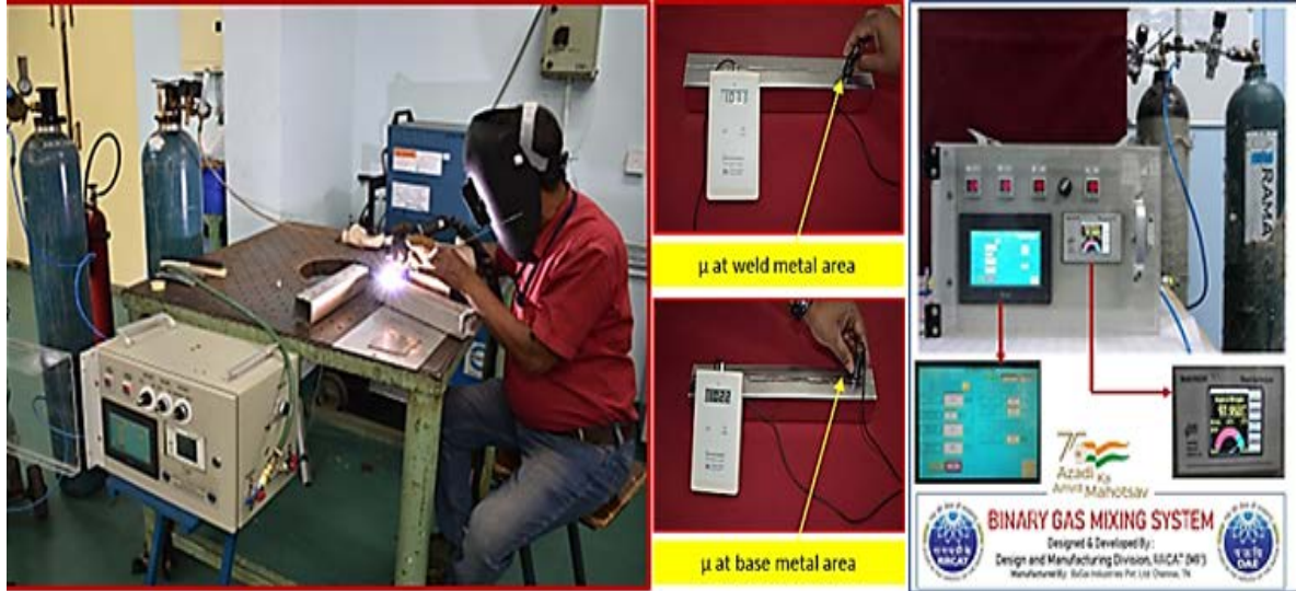
GTA welding of vacuum chamber using Binary Gas Mixing System (BGMS) बाइनरी गैस मिक्सिंग सिस्टम का उपयोग करके वैक्यूम कक्ष की जीटीए वेल्डिंग
