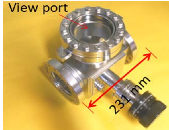
Synchrotron Light Monitor सिंक्रोट्रॉन लाइट मॉनिटर
