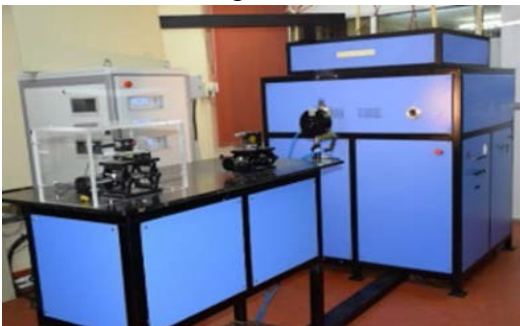
चित्र. 44: 2 kW RF-FAF CO 2 लेसर (दायें) एवं लेसर के चार अनुभागों में RF निस्सरण (बायें)।
