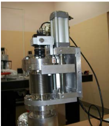
चित्र 5: प्रयोगशाला परीक्षण के दौरान BPM व बेलो एसेम्बली का छाया चित्र।
