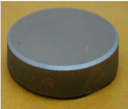
Fig. I.C.1.1: W/B<sub>4</sub>C बहुपरतीय एकसरे दर्पण का आरआरकेट में निर्माण।
