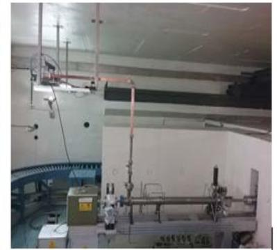
चित्र. II.12.2: ARPF स्थान पर स्थापित की गई 6.0 MW सूक्ष्मतरंग (microwave) प्रणाली एवं इलेक्ट्रॉन गन का छायाचित्र।
