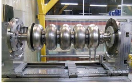
चित्र. II. 1: आरआरकेट में निर्मित पहली 650 MHz ( $\beta=0.92$ ) पांच-सेल अतिचालक रेडियो आवृत्ति गुहिका।
