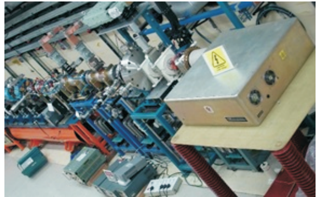
Fig. T.2.4: IR-FEL injector linac section
