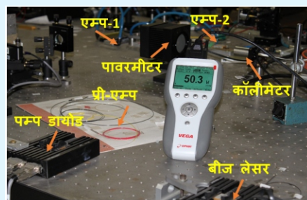
रेखा-चित्र 3 : एकल आवृत्ति संकीर्ण लाइनविड्थ तंतु लेज़र के प्रवर्धन की योजना का छायाचित्र।
